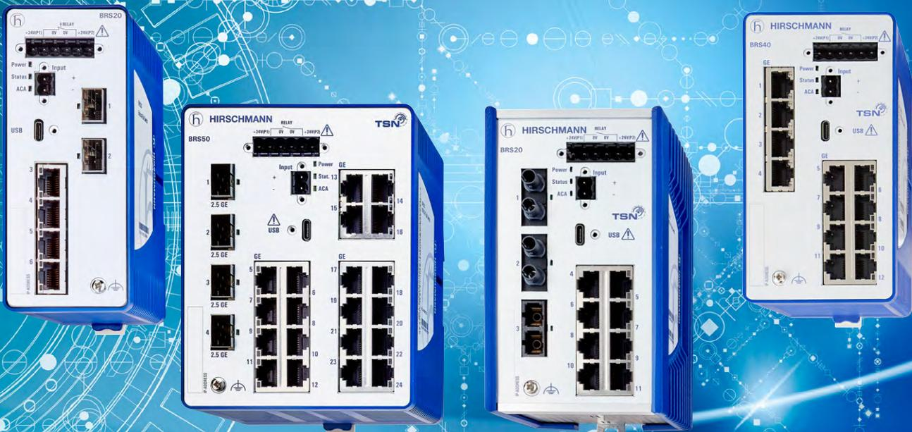
Die BOBCAT Switches von Hirschmann bieten dank vollständiger Kupfer oder Tri-Speed Glasfaser SFP Ports und Abwärtskompatibilität für bestehende Infrastrukturen erweiterte Flexibilität für eine einfache Wartung und einen zukunftssicheren Betrieb.
